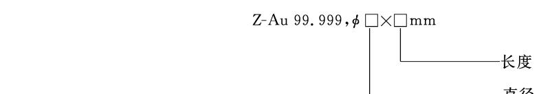
示例: 直径为5 mm、长度为20 mm、成分为99.999%的柱状蒸发金产品 标记为: Z-Au 99.999, φ5×20 mm。
